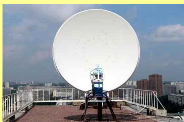
Зеркало с антенным блоком на диапазон 47 ГГц
