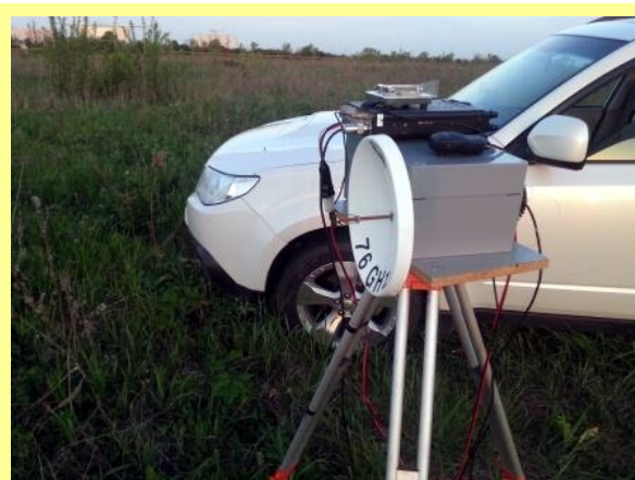
Антенный блок Александра (RN6HW) на диапазон 76 ГГц
