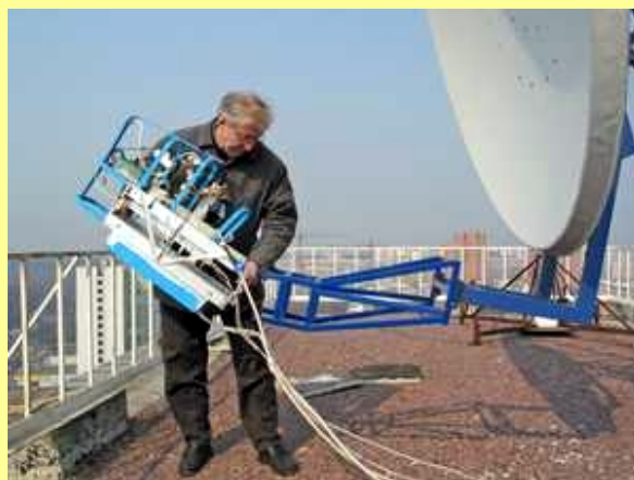
Сергей Жутяев (RW3BP) регулирует антенный блок диапазона 47 ГГц
