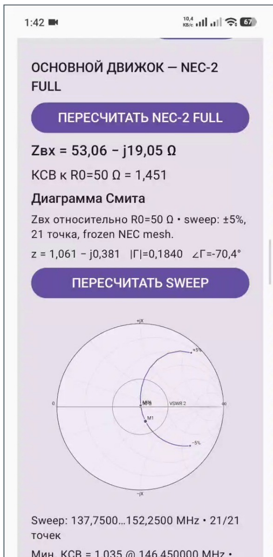
Пример экрана NEC-2 FULL и диаграммы Смита с частотным sweep.
