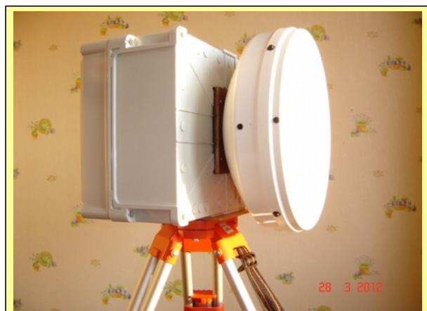
Трансвертер RV3TD с параболической антенной
