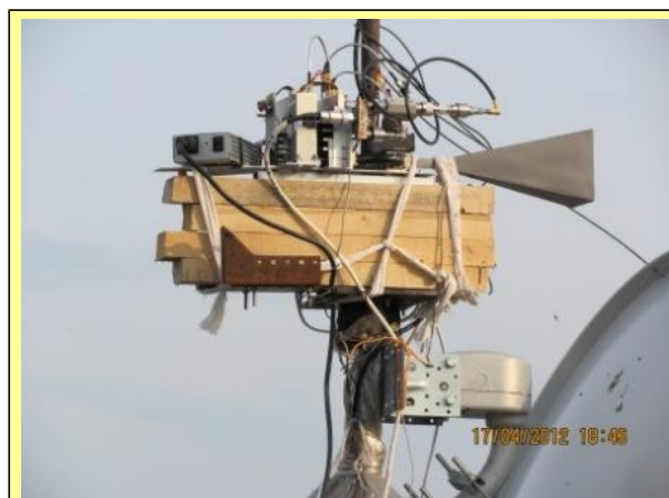
Трансвертер UA3TCF с рупорным излучателем
