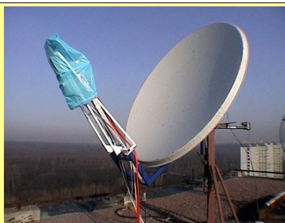
Аппаратура Сергея Жутяева (RW3BP) для EME-QSO на диапазоне 24 ГГц
